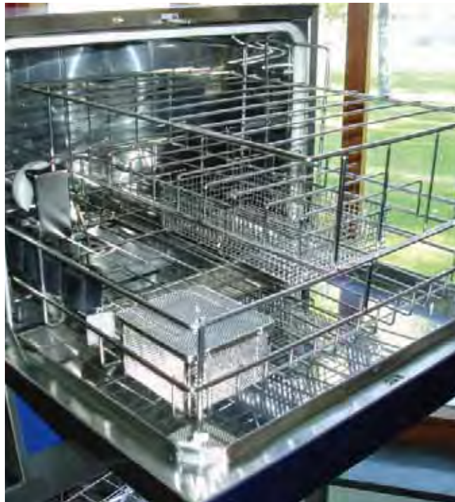
Narzędzia należy najpierw dokładnie umyć. Można to zrobić ręcznie pod strumieniem bieżącej wody, w urządzeniu automatycznym (myjnie-dezynfektory) lub w myjce ultradźwiękowej z użyciem mieszaniny wody i roztworu bakteriobójczego.
